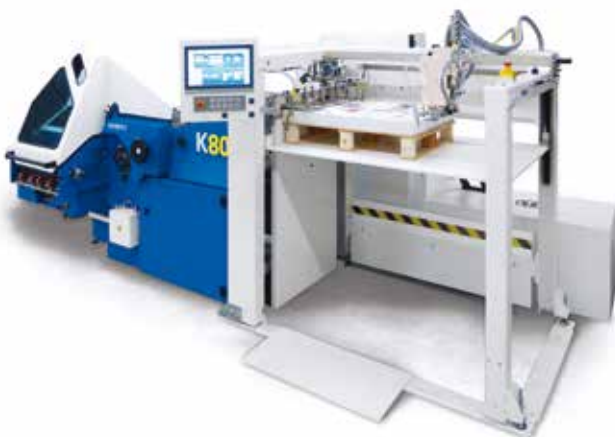
Automatisierte K80 mit Palettenanleger.
